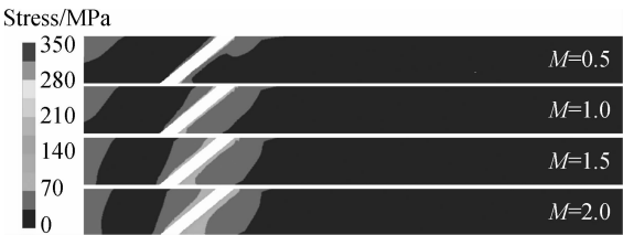
图 22 有复合角平板的子午面的应力云图 (沿 Y 方向看, \alpha=30^\circ , \beta=45^\circ )
